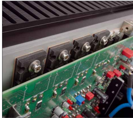
Das ist ein Viertel der Endstufentransistoren eines Monoblocks
