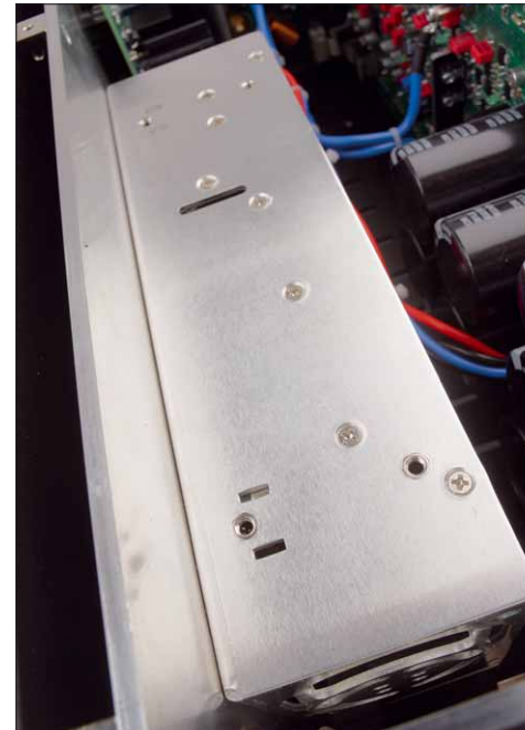
Ein erfreulich leichtgewichtiger Ersatz für einen voluminösen Ringkerntrafo ist dieses Schaltnetzteil in der Endstufe
